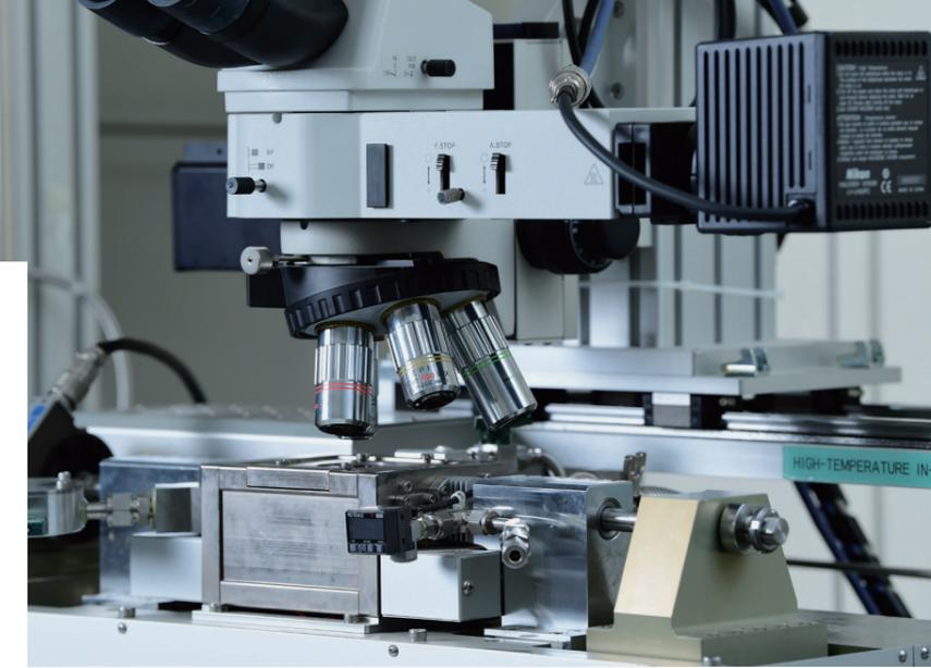
국내에서 유일하게 보유한 공초점주사현미경을 이용한 고온인장시험 및 미세조직 실시간 관찰장비로 철강재의 고온 변형에서의 조직 변화를 실시간 관찰할 수 있어 강재 개발에 유용하다.
